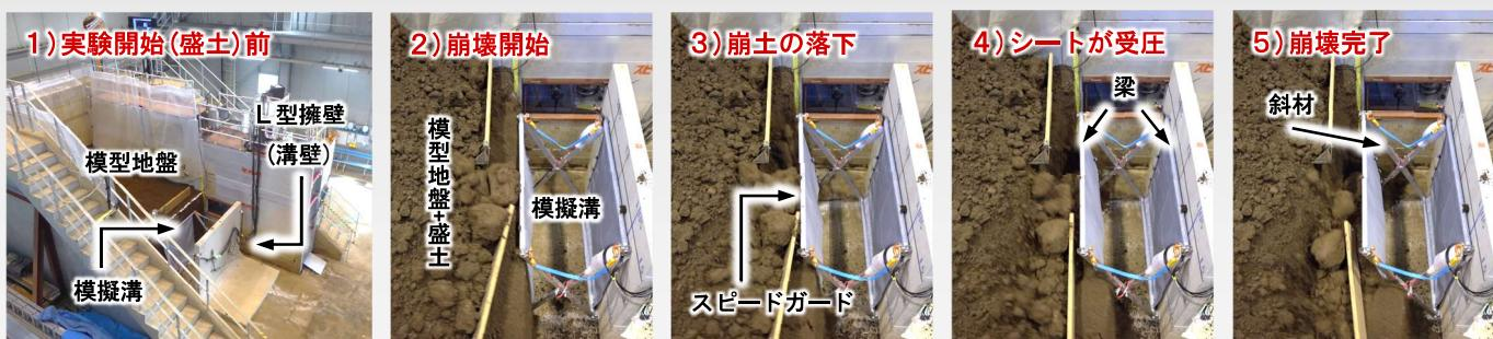
スピードガードに崩土を実際に衝突させた実験の様子です。シートは崩土を受圧すると内側に膨らみますが、土砂を遮断して内部に空間を残します。切梁が無いにも関わらず梁同士の間隔はほぼ一定を保っています。部材に生じた曲げモーメントや張力を解析して構造は最適化されています。
