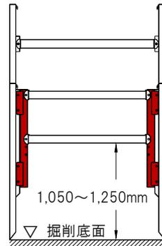
大口径管用補助ガイドを取り付ける事で強度が増し、最下段の切梁を高い位置に設置する事が可能です。又、捨て梁を設置する事なく、大口径管の敷設作業が行えます。
