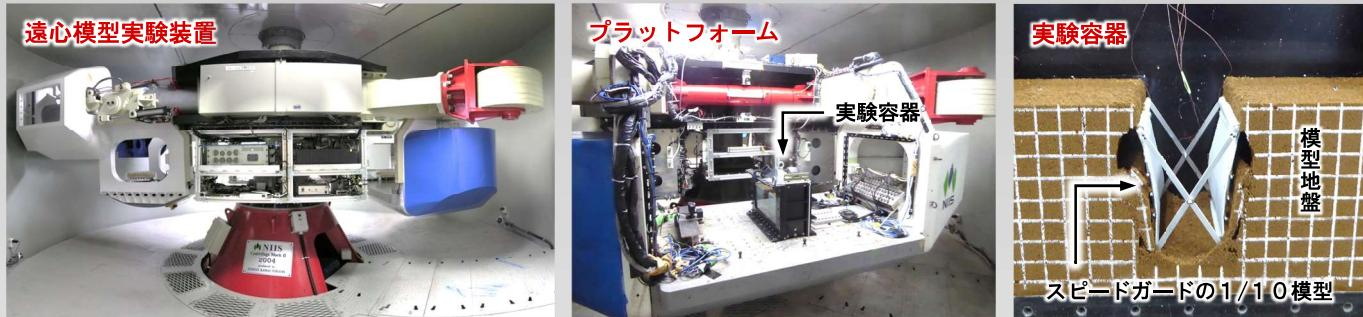
遠心模型実験は $1/n$ の地盤模型に $n$ 倍の重力を作用させることで実物と同じ応力状態を再現できる手法です。本研究では深さ1.5mを基準に異なる深さと幅の溝モデルで崩壊を再現し、土砂遮断の性能を確認しました。
