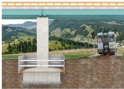
橋脚耐震補強工事
