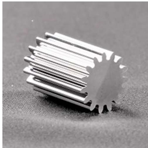
② 超硬 (V3) 20×20mm ワイヤカット3rd 処理時間 5min
