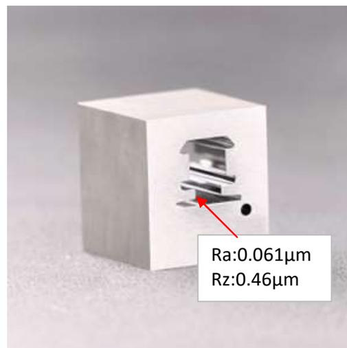
③ トルクパンチ SKH51  $\phi$ 25×25mm 処理時間 3min
