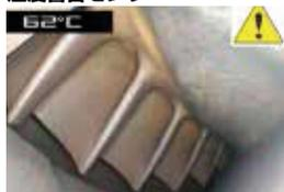
■カメラケーブル先端に温度センサーを装備。ケーブル先端が限界温度に近づくと警告マークを表示します。
