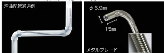
■VJ-ADVは外形6.9mmの挿入部(カメラケーブル)にメタルブレードを採用することで、挿入性と耐久性を大幅に向上。細管の湾曲形状への挿入も手元押込みがスムーズになり、最小クラスの先端硬質長(15mm)が先端の曲がり、通過性を強力にアシストします。
